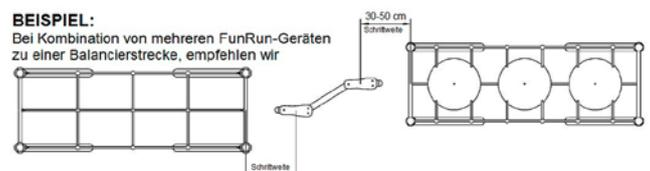
dafür einen Abstand von ca. **30-50 cm**. Eine unabhängige Prüfung nach Installation der Gerätegruppe wird empfohlen.
